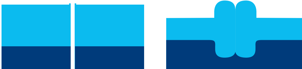
Порамнување и спојување на цевки каде што под притисок се појавуваат топчиња
